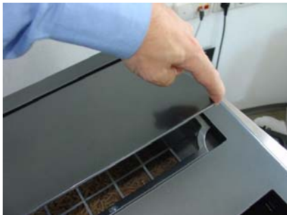
Bild 5: Pellet – Vorratsbehälterdeckel öffnen
